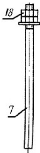
Тип 6 Болты фундаментные с коническим концом
